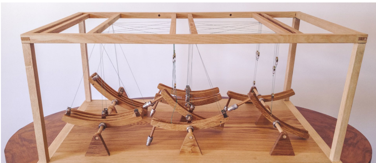
Abb. 6: Das Mechanische Neuronale Netz (MNN) ist ein physikalisches Modell eines KI-Modells und macht alle Komponenten der KI buchstäblich greifbar (vgl. Schaffland & Schöning 2023).
