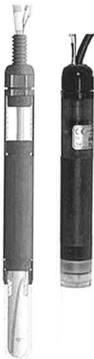
Abb.7: T8-Tensiometer als schematisch Schnitt und Foto (T8 Tensiometer Handbuch, 2009)
