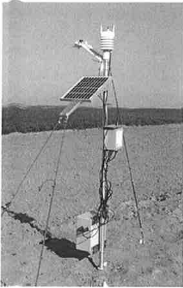
Abb.10: SDI-Log mit Kompakt-Wetterstation und Thetasonden (UP GmbH, Prospekt, 2009)
